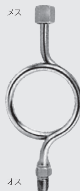
パイプサイホン 材質: SUS ● 最高使用圧力 (耐圧): 20 (30) MPa ● 接続ネジ: G3/8×G3/8 G1/2×G1/2 G3/8×R3/8 G1/2×R1/2
