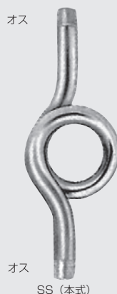
サイホン 材質: SS・SUS ● 最高使用圧力 (耐圧): 1.0 (1.5) MPa ● 接続ネジ: R3/8×R3/8 ● 外装: メッキ又は黒生地 ● SUSは略式です
