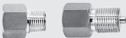
ゲージジョイント材質: BS・SUS ● 接続ネジ (ゲージ取付側×配管側) G1/4×R1/8 G1/4×G3/8 G1/4×R1/4 G3/8×G1/4 G1/4×R3/8 G3/8×G1/2 G3/8×R1/4 G1/2×G3/8 G3/8×R3/8 G3/8×R1/2
